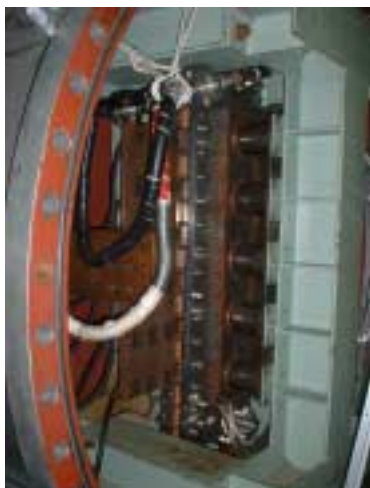
図8.2.1-5 2,500cm 2 2セルスタック 試験状況
