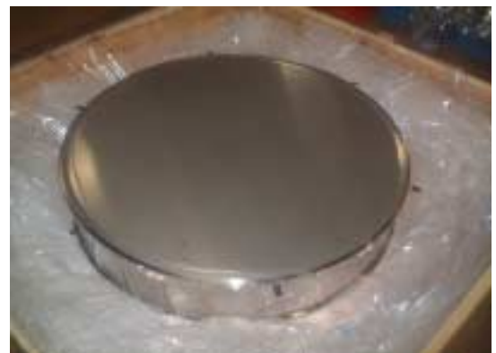
図 9.1.2-2 真空パネル型断熱構造試験体外観
