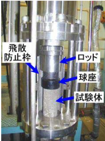
図 9.1.2-4 LH 2 試験における試験体取付状況
