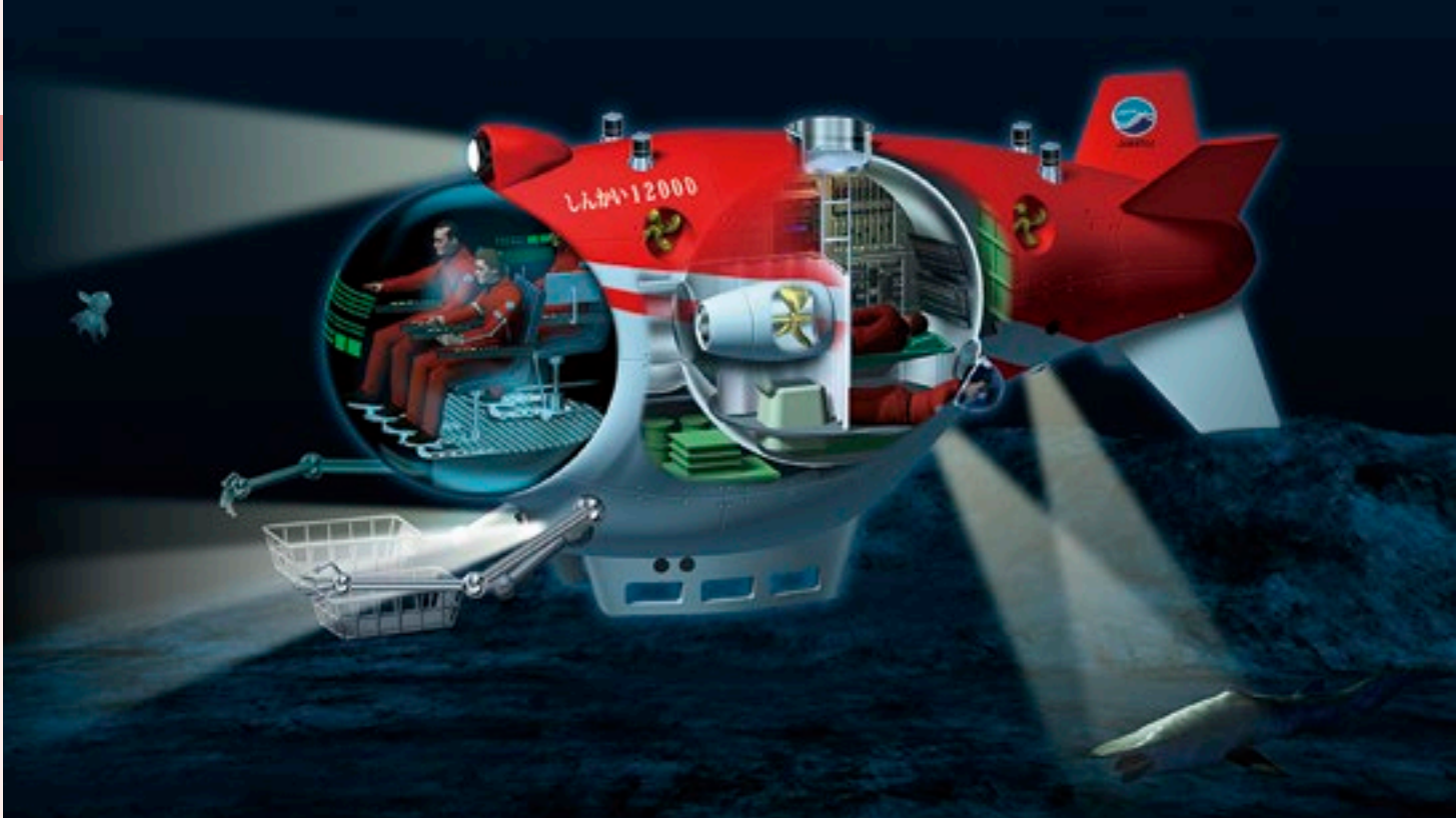
水深12,000mまで潜航できる次世代の有人潜水調査船「しんかい12000」のイメージ ©JAMSTEC
